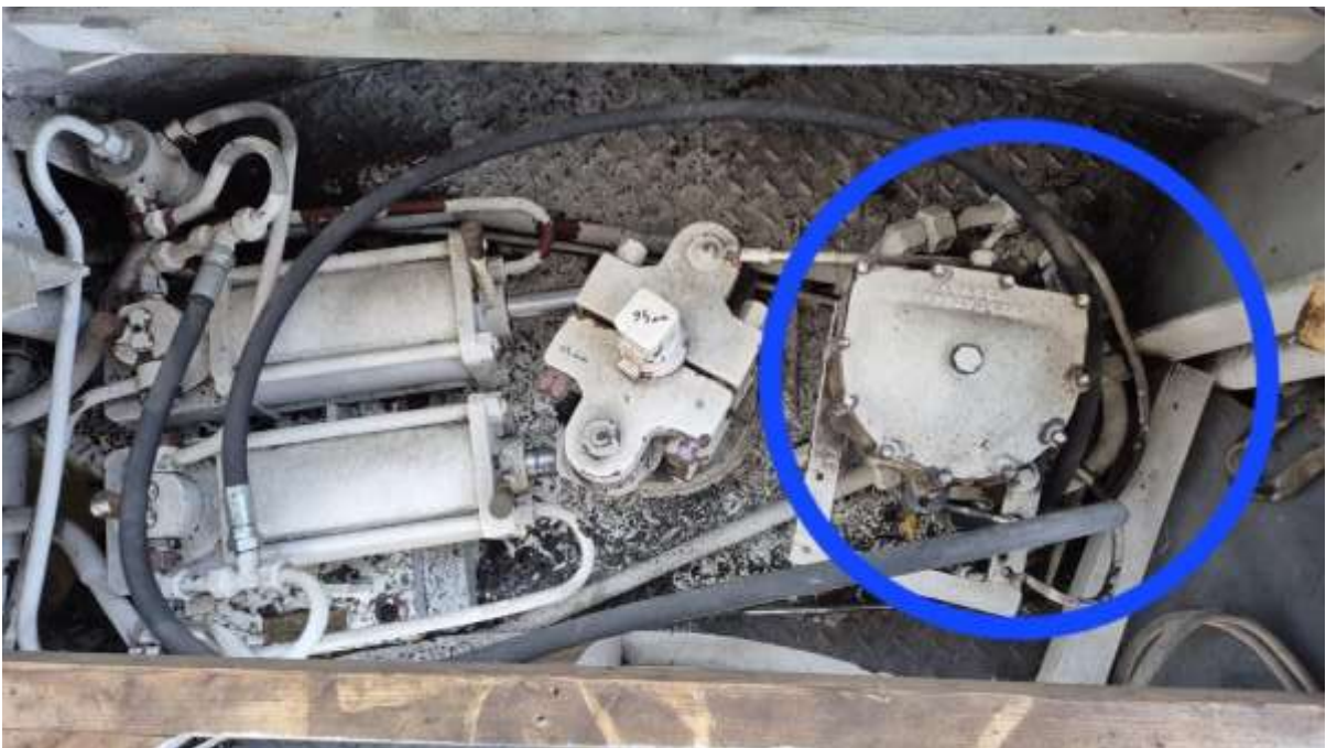
Kuva 5, peräsimen ohjainyksikkö (Sami P.)
